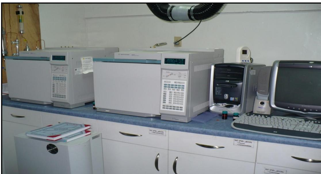
Cromatógrafo de Gases AGILENT 6890 con Detector de Microcaptura de Electrones (equipo completo).
