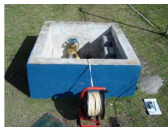
Foto N° 4. Vista de la Pozo, en el momento de la medición del nivel estático y la georeferenciación del pozo con GPS (elevación y coordenadas UTM).
