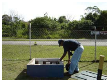
Foto N° 5. Vista del Pozo ubicado en la parte frontal. Medición del nivel de agua en el pozo por medio de la sonda manual.
