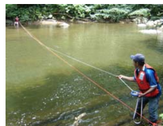
Foto N° 2 Aforo en el río: Medición del ancho total del río.
