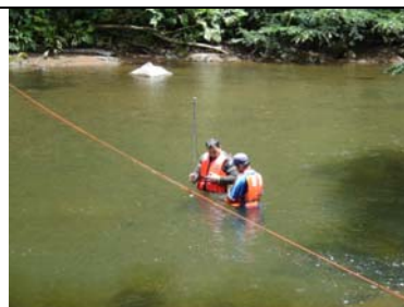
Foto N° 6 Otra vista en el centro de la sección de río, midiendo la velocidad con el Correntómetro
