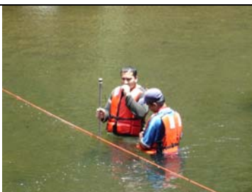
Foto N° 5 Medición de la velocidad en la sección de aforo del río con el Correntómetro digital marca SWOFFER
