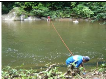
Foto N°1 Trabajo inicial para el aforo: colocación de sogas y división en secciones del río.
