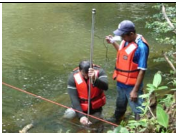
Foto N° 3 Aforo en el río: Medición de profundidad en las secciones del río.
