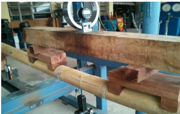
*Proyecto: Caracterización Físico-Mecánica de Elementos de Columnas Sometidos a Compresión y Elaborados con Guadua.
