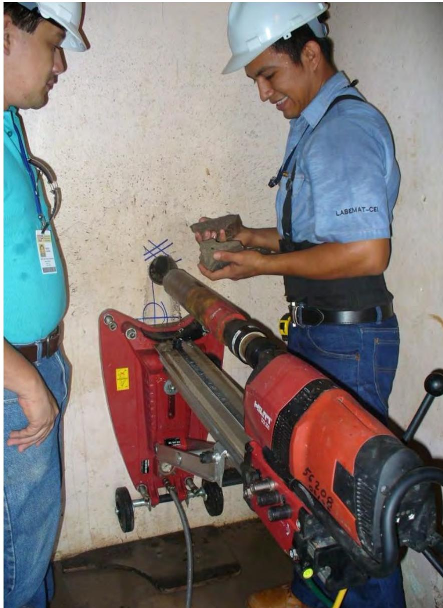
*Extracción de especímenes de concreto, efectuada por el Centro Experimental de Ingeniería, en la Escuela de Gualaca en Chiriquí*
