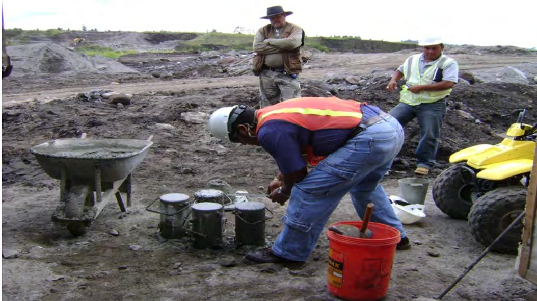
Pruebas de calidad del concreto realizadas para la empresa Concretos S.A. en Bugaba, Chiriquí
