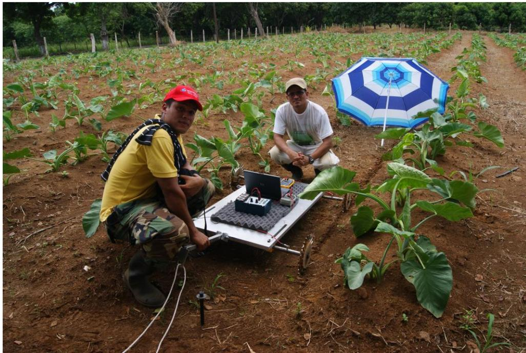
*Sistema de tracción para la medición automática de la resistividad eléctrica aparente de los suelos con GPS incorporado que permite la rápida evaluación de las zonas de alto rendimiento agrícola*
