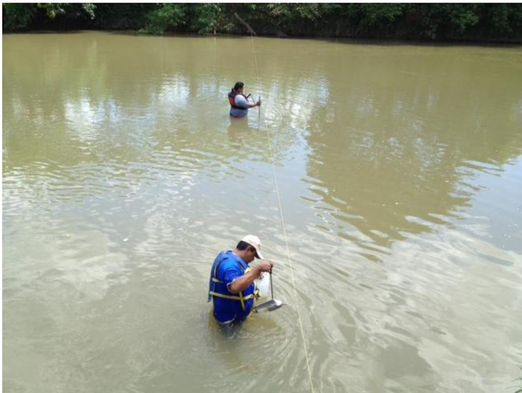
*Vista de la realización de un aforo en Natá, Coclé por personal del Centro de Investigaciones Hidráulica e Hidrotécnica*
