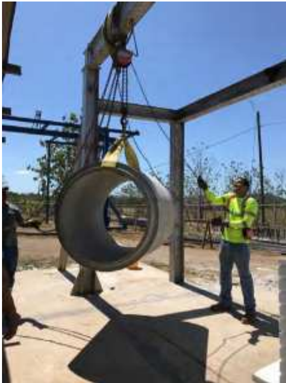
Ensayos de compresión a tuberías de concreto, Centro Regional de Veraguas.
