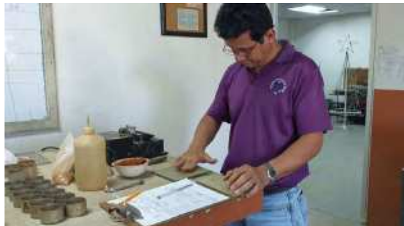
Prueba de límites de Atterberg, con la cual se mide la consistencia y plasticidad del suelo, Centro Regional de Chiriquí.
