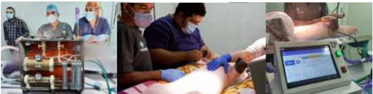
Prototipo de Ventilador de UTP - 100 P y pruebas en cerdos.
