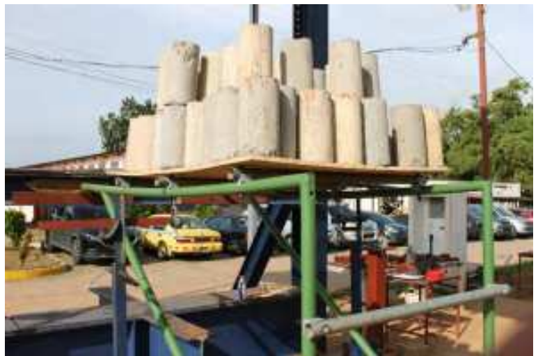
Pruebas de ensayo de andamios de albañilería.
