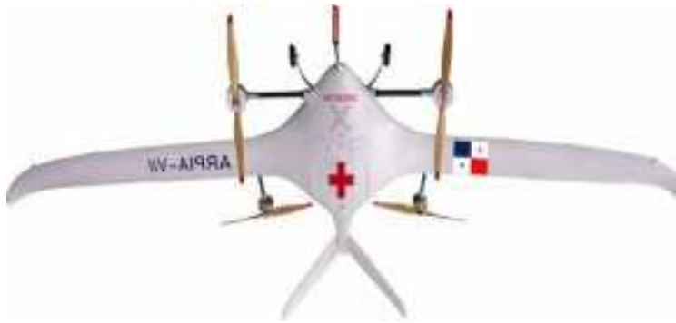
Vehículo aéreo no tripulado, pilotado remotamente o autónomo para enviar medicamentos. Proyecto realizado en el Laboratorio Flying Labs - UTP, en conjunto con la empresa Helidrones, S.A.
