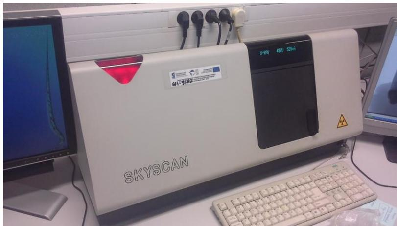
Figura 3. Equipo de Rayos X para hacer inspecciones en 3-D
