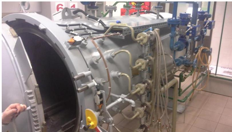
Figura 4 Horno autoclave para fabricación de materiales compuestos
