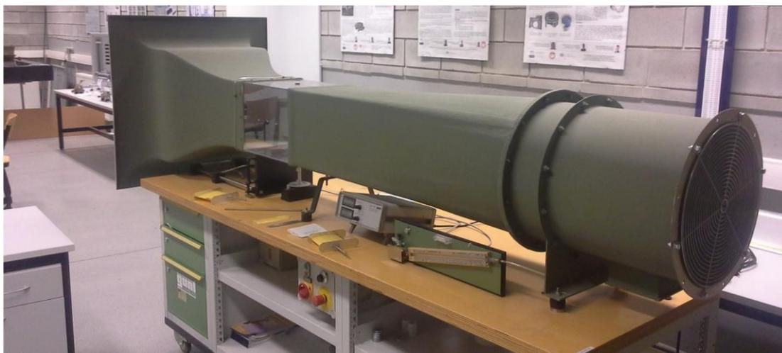
Figura 12. Túnel de viento subsónico de circuito abierto. Con las capacidades de manufactura de la universidad han logrado crear modelos probados en la sección de prueba. (Créditos: Oscar Garibaldi)
